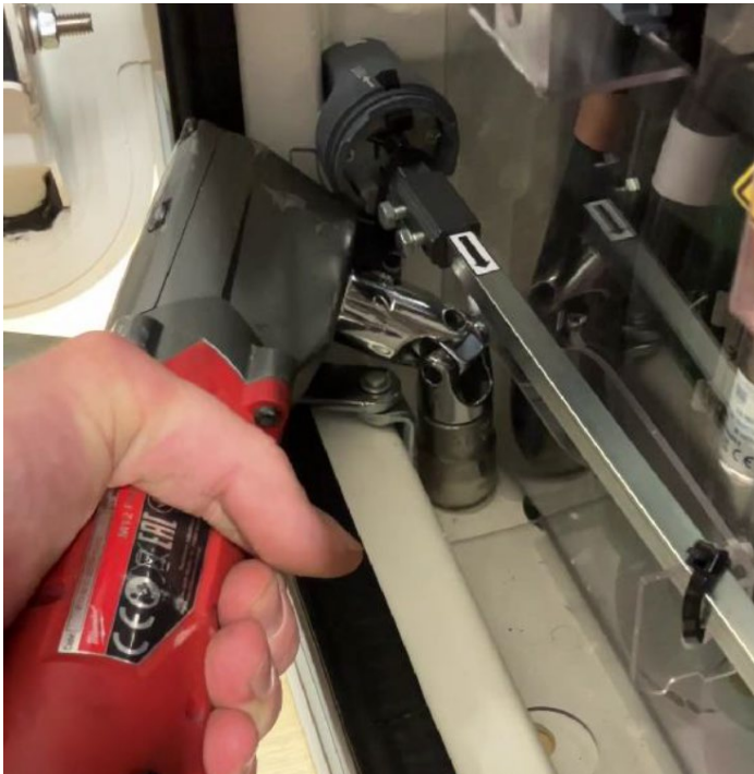
Afbeelding 43: Hoekadapter inzetstuk voor palletschroefverwijdering
