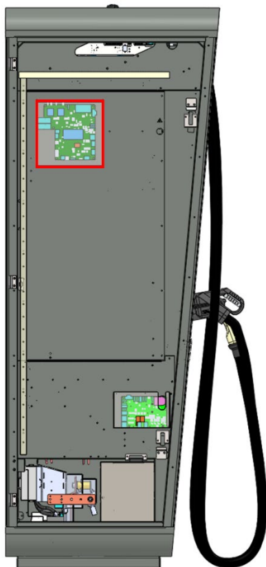
Afbeelding 30: Positie van de CTRL_COM in de Hypercharger
